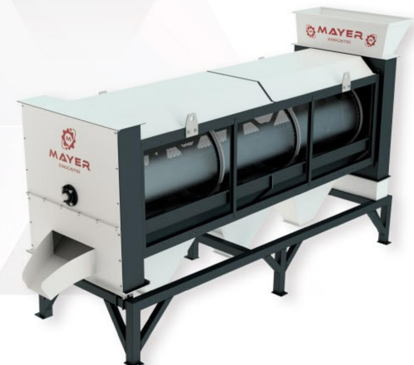
Döner elekler, içerisinde yerleştirilmiş belirli ebatlarda delikleri olan bir tamburun döndürülmesi ile içersine atılan atığı çeşitli ölçülerde ayıklanan makinelerdir.
